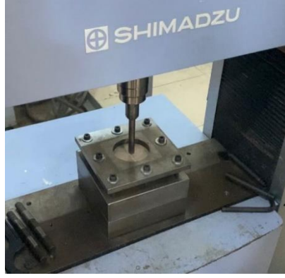
Görsel 1. Yarı Statik Delme Kesme Deneyi Düzenegi
