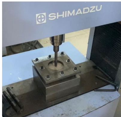
Görsel 1. Yarı Statik Delme Kesme Deneyi Düzeneği
